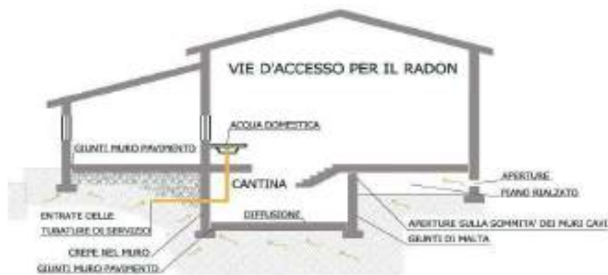
Figura 8: vie d'accesso per il radon
