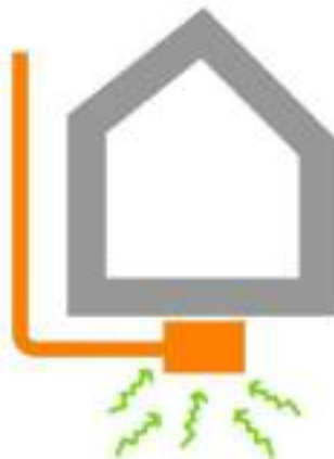
Figura 16: depressione del sottosuolo tramite pozzetto.
