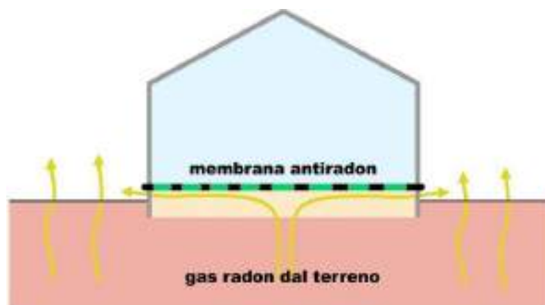
Figura 9: una membrana impermeabile antiradon di separazione fra l'attacco a terra e l'edificio è un sistema efficace nei confronti dell'ingresso del radon nelle abitazioni, purché attentamente posata.
