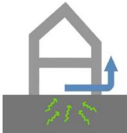
Figura 15: depressione di un volume tecnico alla base dell'edificio
