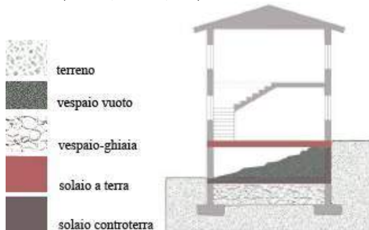
Figura 30: il solaio a terra costituisce la linea di separazione fra volumi abitati e volumi non abitati
